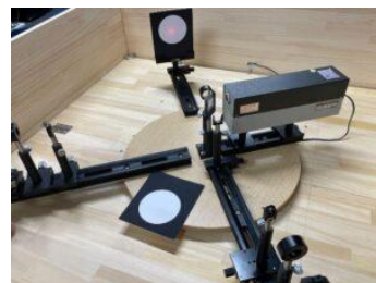
【レーザー干渉計模型】 重力波観測のしくみがわかるレーザー干渉計の模型です。(大阪工業大学 製作)
