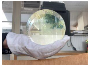
【KAGRA サファイア鏡】 重力波望遠鏡ではレーザー光を鏡で反射させて戻ってきた光のわずかな位相差(到達時間の違い)を測定することで重力波を検出します。実験で使用された貴重なサファイア鏡を展示します。 (東京大学宇宙線研究所 所蔵)
