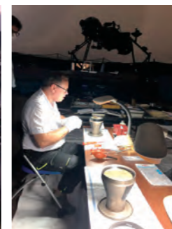
恒星投影機(星座の星を投影するユニット)の分解清掃
