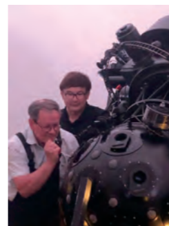
恒星投影機(星座の星を投影するユニット)の分解清掃
