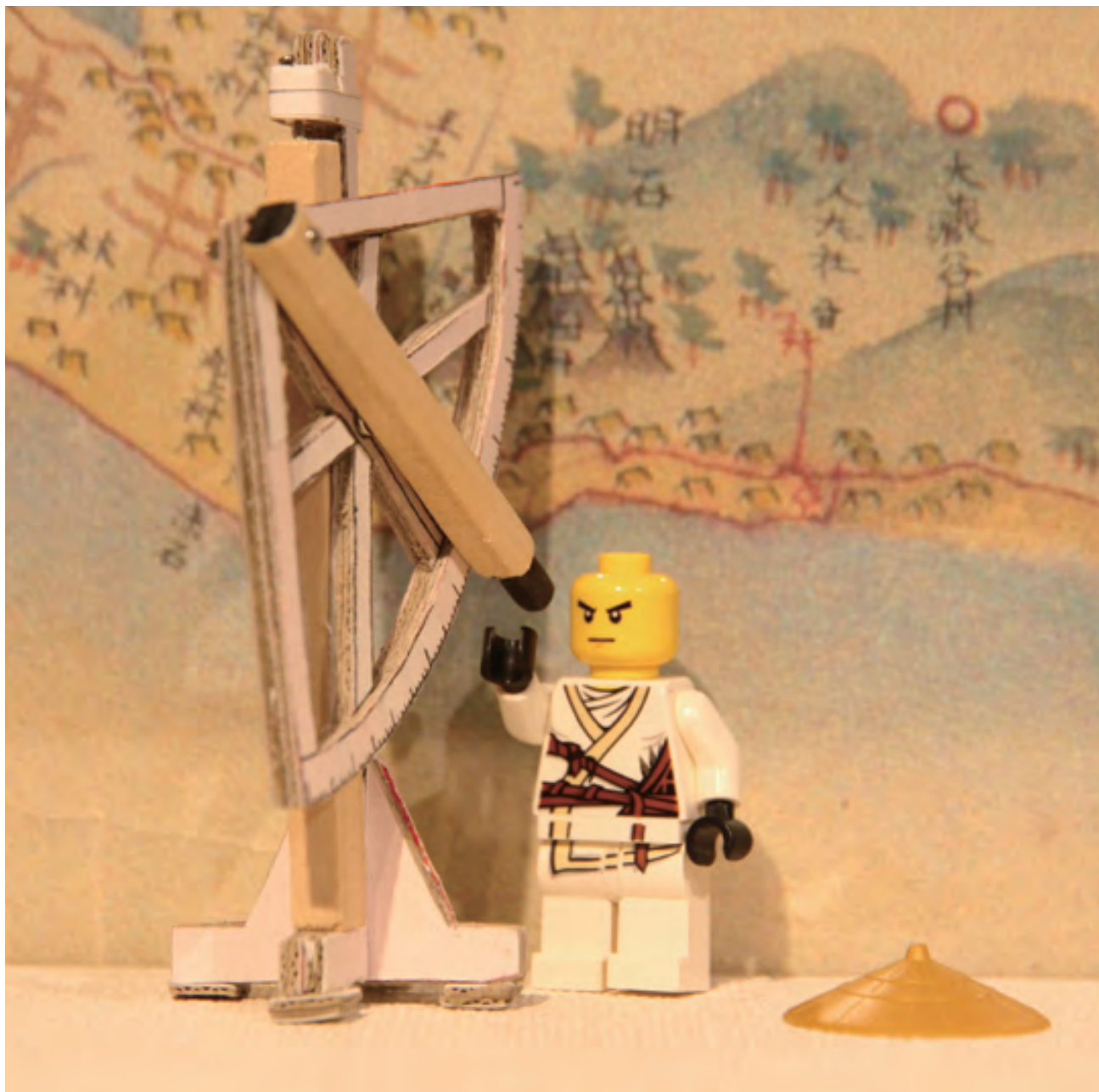
伊能忠敬が星の高度を測るとき用いた象限儀(模型) 提供：大西道一さん
